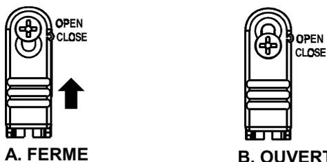
Figure 29. Déverrouiller l'Etrier
