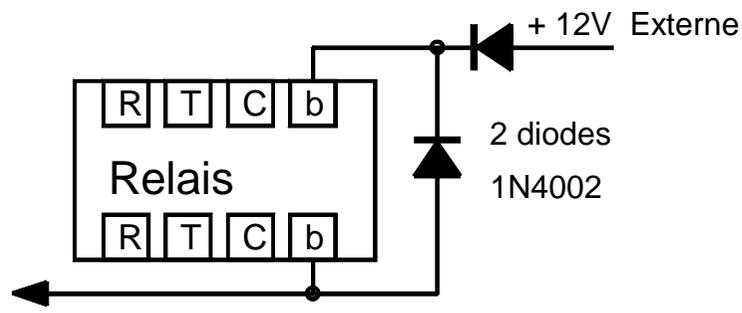
Télécommande 0 à l'arrêt : contact entre C et R.
