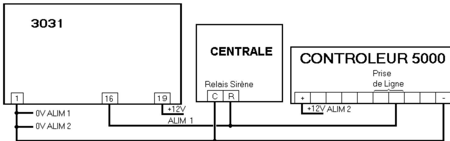
La sortie prise de ligne (borne 16) est à 0V hors prise de ligne et en collecteur ouvert en prise de ligne. Ce raccordement permet d'éviter d'enregistrer des prises de ligne ne correspondant pas à des alarmes .
