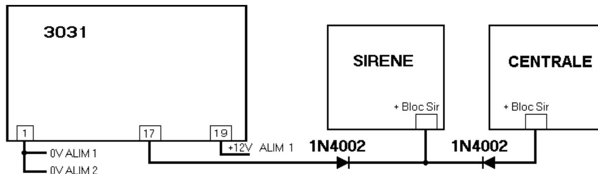
La sortie +12V de blocage sirènes (borne 17) est active à +12V (collecteur ouvert). Cette sortie est active seulement pendant l'écoute.
