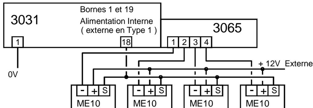
Les microphones d'écoute seront sélectionnés par rapport à la dernière entrée ayant déclenché : si l'entrée 1 déclenche puis l'entrée 2, le microphone sélectionné est le microphone raccordé à S2.
