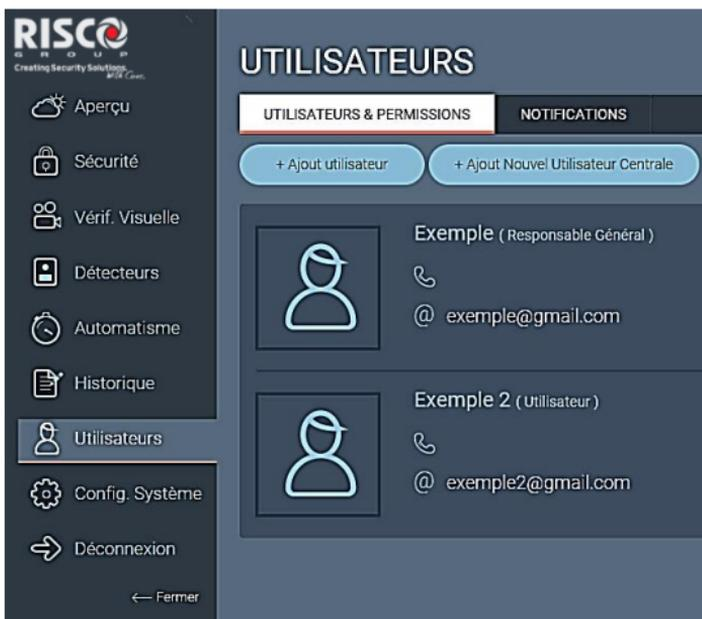
4. Sélectionnez “+Ajout Nouvel Utilisateur Centrale” pour ajouter un utilisateur qui peut contrôler le système uniquement depuis le clavier de la centrale, s’il est installé.
