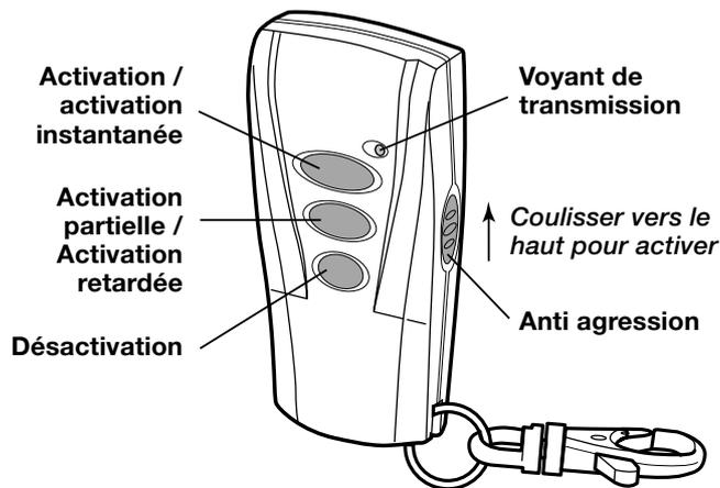
La télécommande est également munie d'un bouton d'Anti Agression. Le fait d'activer celui-ci (sur le côté de la télécommande) déclenchera immédiatement une alarme complète, que le système soit activé ou non. L'alarme peut être annulée en appuyant sur le bouton 'Désactivation' de la télécommande ou depuis la centrale sirène.
