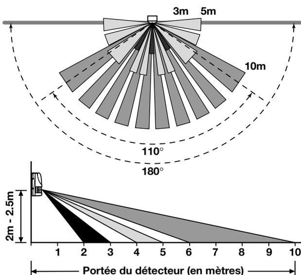
Schéma de zone de détection pour une carte de circuit imprimé en position 5
